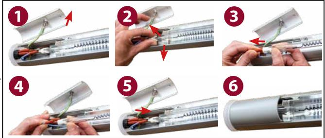
2. **Rimuovere l'elemento riscaldante:** Estrarre l'elemento riscaldante. Assicurarsi di non colpire il tubo per evitare la rottura del tubo.
