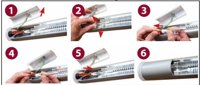
2. **Heizelement entnehmen:** Ziehen Sie das Heizelement heraus. Achten Sie darauf, dass Sie die Röhre nicht anschlagen, um einen Bruch der Röhre zu verhindern.
